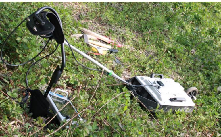
Bodenradarmessgerät des LWL
